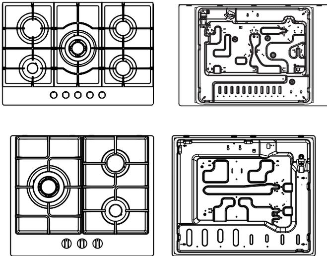
1. Retire o suporte para frigideiras, a tampa do bico do fogão e o espalhador de chamas e vire o aparelho de cabeça para baixo e coloque-o sobre o tapete almofadado. Tenha cuidado para que o equipamento de arranque e o equipamento de supervisão de chama não sejam afetados nesta operação.
