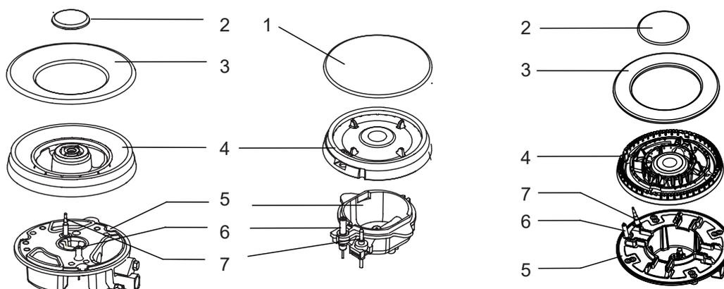
1. Coloque o espalhador de chama (4) no encaixe do bico do fogão (5), para que o equipamento de ignição e o equipamento de monitorização de chama se expandam para os seus respetivos furos. O espalhador de chamas deve fazer um clique corretamente.
