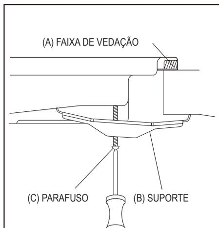
1. Posicione o suporte (B) alinhando-o sobre os orifícios dos parafusos. Existe um conjunto de furos para parafusos em cada canto da placa (H) Aperte ligeiramente um parafuso (C) na direção do suporte (B), de modo que o suporte se prenda à placa, para que possa ajustar a posição.
