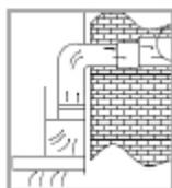
Si existe en su cocina un conducto debajo de los módulos de pared, el tubo extractor puede instalarse de modo que el aire extraído pueda evacuarse horizontalmente a través de la pared.
